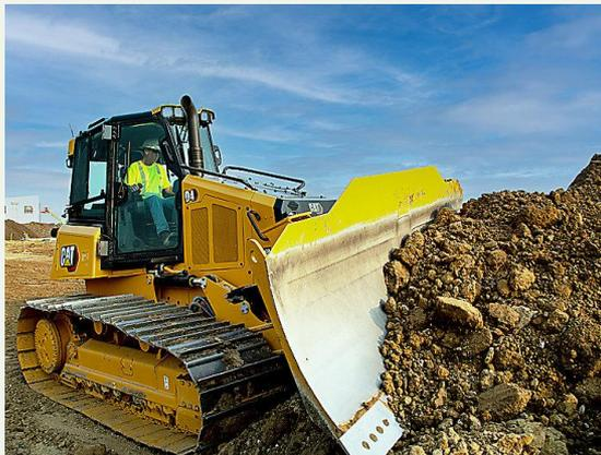
Caterpillar apripista 10t per realizzazione di fasce tagliafuoco all'interno del poligono
